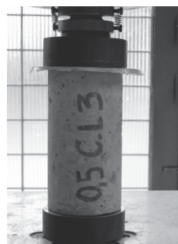
Figura 10. Especimen en proceso de falla
