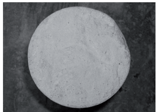
Figura 16: Cara superior no uniforme y con
